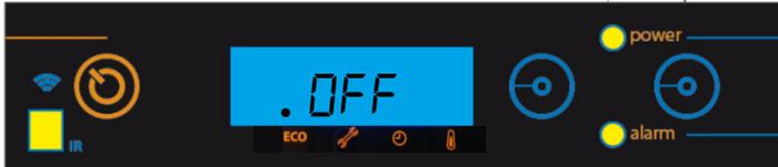
g) Quando atingimos as 2100 horas de funcionamento da salamandra, essa informação fica visível no display, O cliente deve fazer a manutenção ao equipamento e só depois reiniciar o contador de horas (acesso através do Menu Técnico) para eliminar a mensagem, não influencia o normal funcionamento do equipamento, é apenas um aviso. Exemplo:
