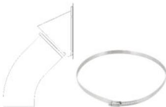
**Figura 17 – instalação boca de carga e abraçadeira metálica**
