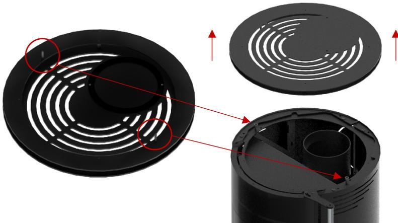
**Figura 10 - Desmontagem do tampo no equipamento**
