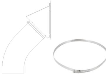
Figura 14 – instalação boca de carga e abraçadeira metálica.
