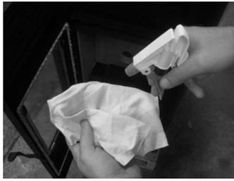
Figura 63 – Limpeza do vidro: Aplicar líquido no pano
