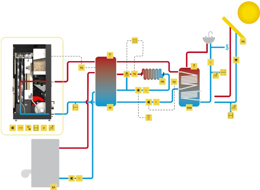
**Figura 35 - Ligação a chão radiante, conjugado com outra salamandra de apoio e águas sanitárias combinado com painel solar**
