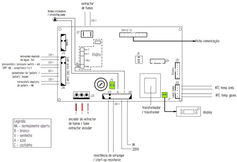
Figura 37 - Esquema eléctrico First Hydro 13 Kw
