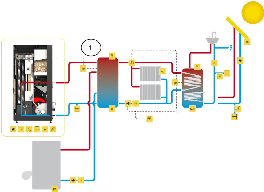
**Figura 34 - Ligação a radiadores de aquecimento central, conjugado com outra salamandra de apoio e águas sanitárias combinado com painel solar**
