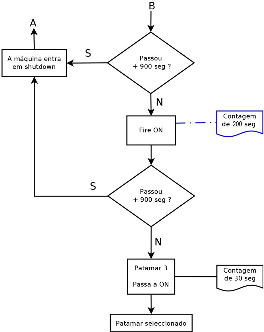
• Fluxogra 2 – Desligar a máquina
