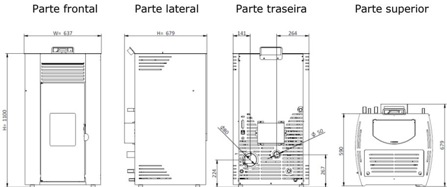
**Figura 2 - Dimensões da salamandra First Hydro 13 kW de pellets**
