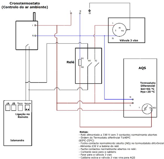
**Figura 33 - Ligação eléctrica de um cronotermostato (controlo do ar ambiente) de um termostato diferencial ligado ao depósito de AQS e da válvula de três vias a uma caixa de relés**
