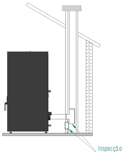
**Figura 8 – Vista lateral da instalação com chaminé, com exemplo do ponte de inspecção**
