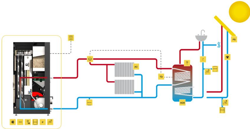
**Figura 32 - Ligação a radiadores de aquecimento central e águas sanitárias combinado com painel solar**
