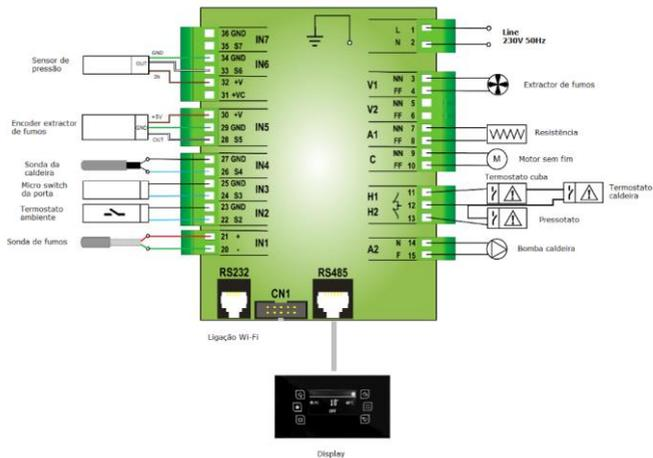
Figura 38 - Esquema eléctrico – Aplicável à electrónica Columbus
