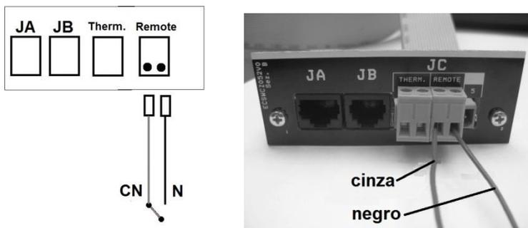
**Figura 19 – Ligação do comando externo com fios**
