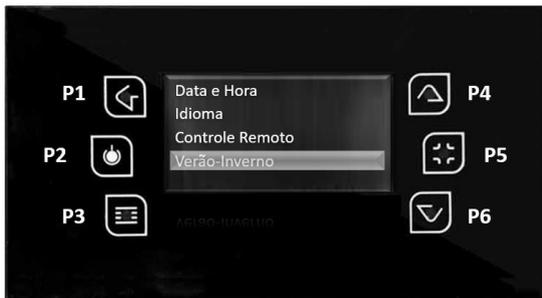
Pressionando as teclas P4 e P6, pode escolher entre o modo Verão ou Inverno, este Menu permite modificar o funcionamento da central hidráulica em função da estação do ano. Use a tecla P3 para validar a escolha.
