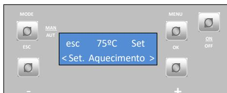
**Nota:** no equipamento a água, a temperatura da água pode ser regulada pelo utilizador (temperatura de set-point da água) entre 50 e 80°C.
