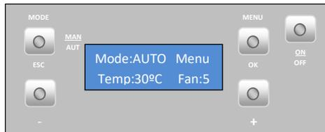
**Modo "auto":** neste modo a máquina vai ligar na potência máxima e permanecer nela até atingir uma temperatura 1°C acima da temperatura seleccionada (temperatura de set point). Quando atinge essa temperatura passa a funcionar na potência mínima.
