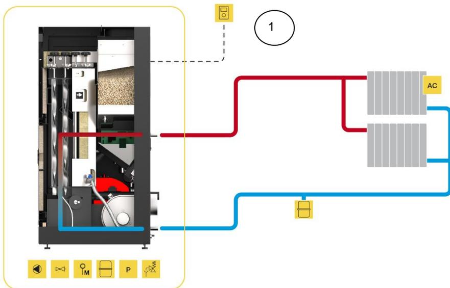
**Figura 31 - Com ligação simples apenas a radiadores de aquecimento central**
