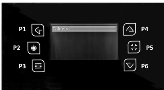
Este submenu permite modificar o valor do termostato da Caldeira, com as teclas P4 e P6. Os valores mínimo e máximo podem ser programados.
