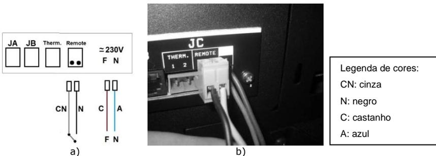
**Figura 18 – Ligação do comando remoto sem fios**
