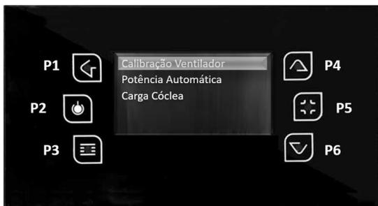
Neste submenu com as teclas P4 e P6 pode ajustar a velocidade do ventilador, entre -7 (-21%) e 7 (+21%). Para voltar ao menu Service pressione P1.
