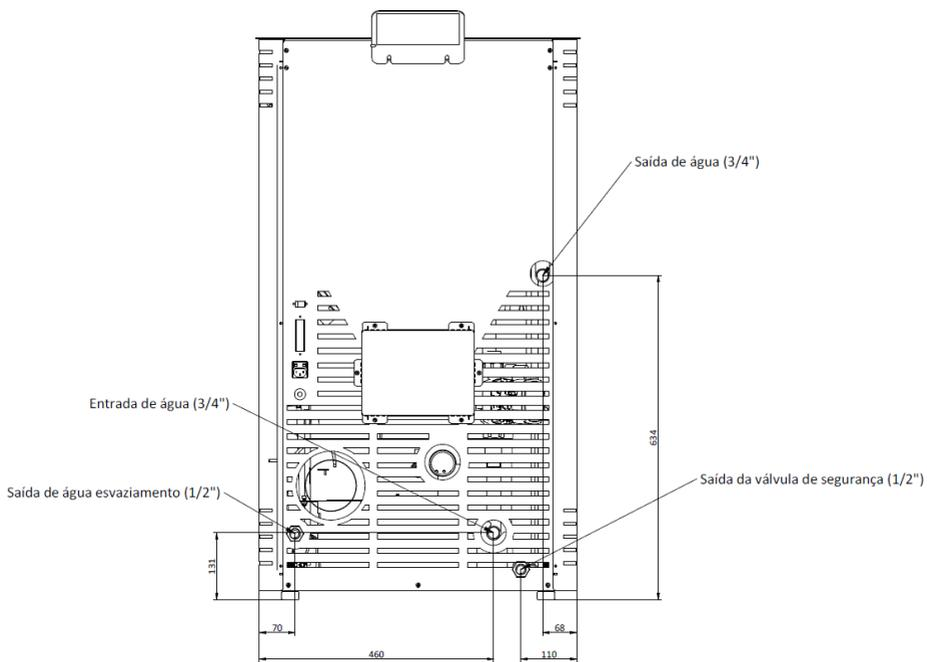
**Figura 3 - Ligações hidráulicas da salamandra First Hydro 13 kW de pellets**
