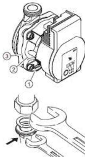
**Figura 44 – Instalação da bomba**
