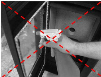
**Figura 28 – Limpeza incorrecta do vidro**
