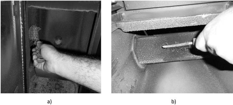
**Figura 21 – Limpeza do interior da Compacta a água**
