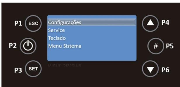
Com a tecla P6 seleccione o submenu Verão-Inverno e para validar a entrada neste submenu a tecla P3.
