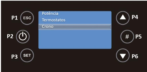
Seguidamente deve entrar no submenu Programa, usando a tecla P6 para seleccionar e P3 para validar a escolha.
